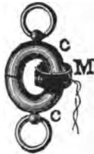
FIG. 48. FERRIC MAGNETIC CIRCUIT.
